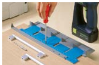
Сверлильный кондуктор BlueJig Handle позволяет быстро и просто установить ручки-скобы и ручки-кнопки.
