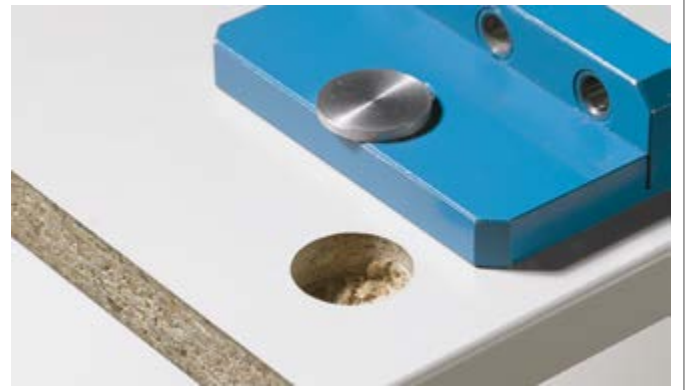
Для разметки сверления для стяжной фурнитуры (VB)
