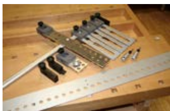
Сверлильный кондуктор Ассига с различными шаблонами. Практичная модульная система для широкого применения
